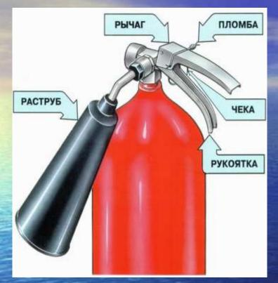
приведение в действие углекислотного огнетушителя
