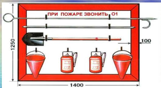
ПРЕДНАЗНАЧЕН для размещения первичных средств пожаротушения, немеханизированного инструмента и пожарного инвентаря в производственных и складских помещениях, не оборудованных противопожарным водопроводом и автоматическими установками пожаротушения, а также на территории предприятий, не имеющих наружного противопожарного водопровода, или при удалении зданий (сооружений), наружных технологических установок на расстояние более 100 м от наружных пожарных водоисточников.
