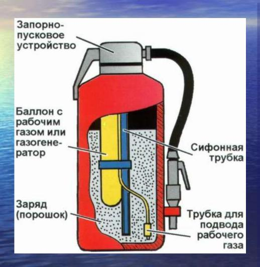
Принцип действия: При срабатывании запорнопускового устройства прокалывается заглушка баллона с рабочим газом (углекислый газ, азот). Газ по трубке подвода поступает в нижнюю часть корпуса огнетушителя и создает избыточное давление. Порошок вытесняется по сифонной трубке в шланг к стволу. Нажимая на курок ствола, можно подавать порошок порциями. Порошок попадая на горящее вещество, изолирует его от кислорода и воздуха
