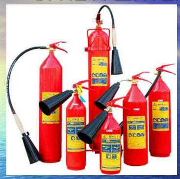
Огнетушители углекислотные (ОУ) предназначены для тушения различных веществ, горение которых не может происходить без доступа воздуха, а также электроустановок, находящихся под напряжением до 1000 В.
